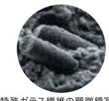
特殊なガラス繊維を配合。塗膜表面の傷付きを抑える硬度とともに、曲げ加工に柔軟に追従するしなやかな加工性も兼ね備えています。
