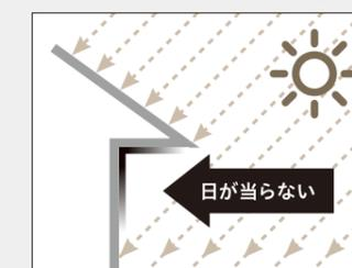
腐食は端面部や塗膜の傷部(加工部の傷を含む)から進行します。腐食の進行に伴い、塗膜が膨れ、白錆が発生します。
