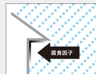
軒下部に塩分が付着・堆積すると雨により洗い流されない事に加え、日が当たらず乾燥しにくい、濡れ時間が長くなり、腐食が促進されます。
