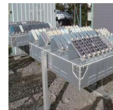
曝露試験設備
