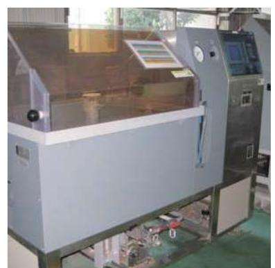
サイクル腐食試験設備
